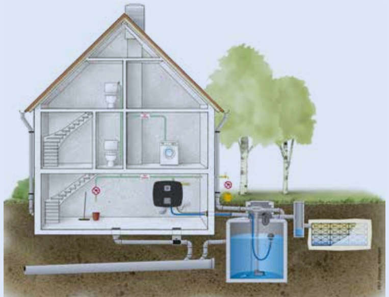
Regenwatersysteem met kinderveilige regenwaterput en KIWA gecertificeerde pomp
